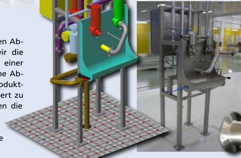
R+I Schema, 3D-Zeichnung und fertige Anlage einer molchbaren Transferlinie für den Transfer mit mobilen Pumpen
